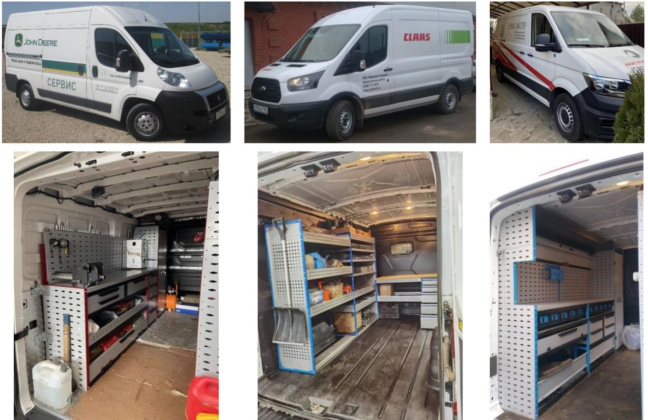
Рисунок 1.8 – Сервисные автомобили дилеров и средства для осуществления ТО и ремонта
