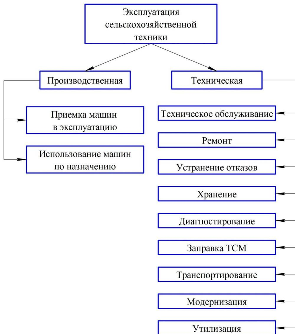
Рисунок 1.5 – Схема эксплуатации сельскохозяйственной техники
